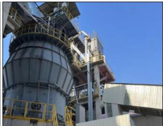
外循环斗提废气除尘器
