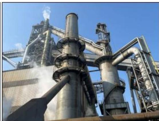
高炉渣粒化废气空冷消白
