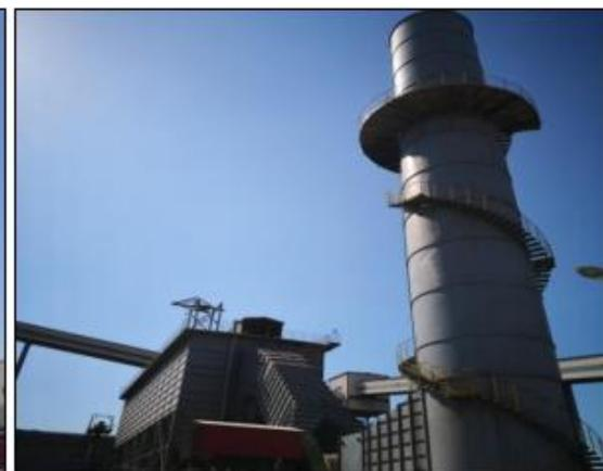
转炉二次废气袋式除尘器
